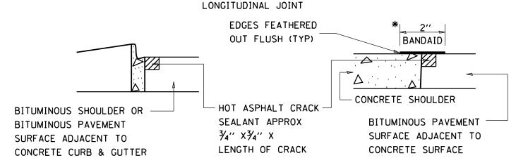
CRACK & JOINT SEALING DETAIL
