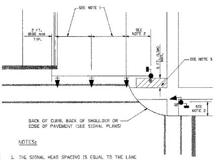
WIDTH OR AS SHOWN ON THE TRAFFIC SIGNAL PLAN.
