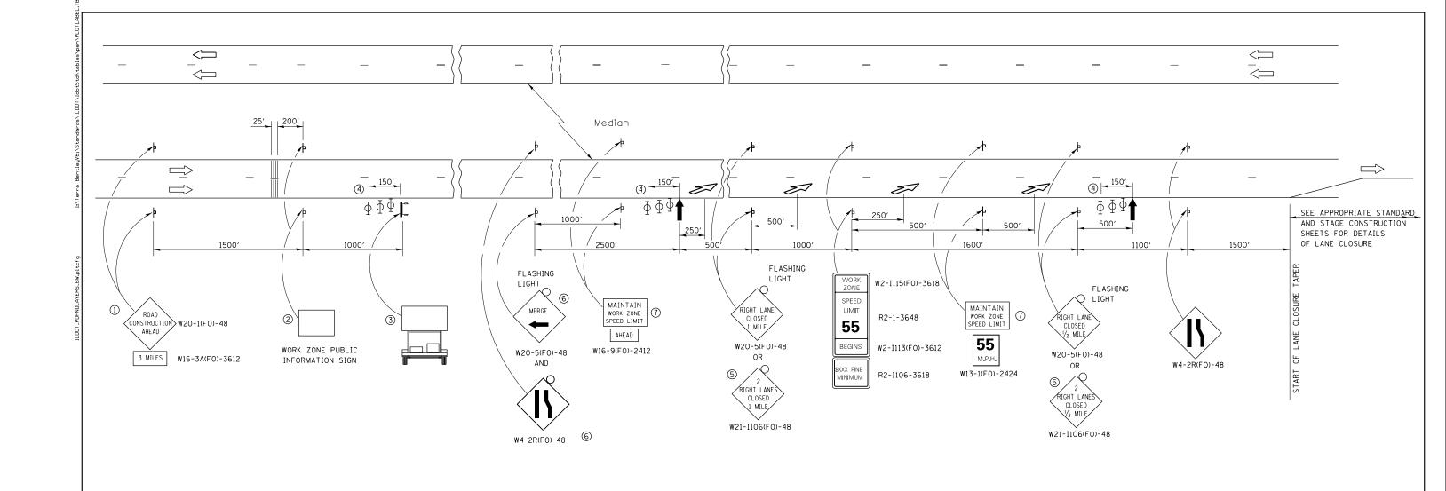
THE ROAD CONSTRUCTION AHEAD SIGN SHALL BE LOCATED 3 MILES IN ADVANCE OF THE PROJECT LIMITS.
