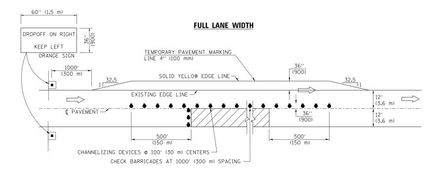
TRAFFIC CONTROL DETAILS NOT SHOWN SHALL BE ACCORDING TO TRAFFIC CONTROL STANDARD 701401.
