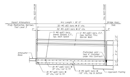
INSIDE ELEVATION OF BARRIER WALL NO. 2
