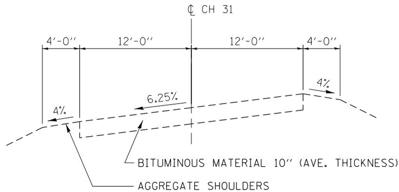
**EXISTING TYPICAL SUPERELEVATION SECTION**
