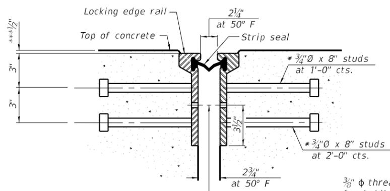
SHOWING ROLLED RAIL JOINT
