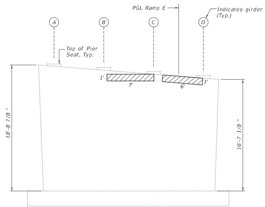
**PIER 4 REPAIRS - EAST FACE ELEVATION**
