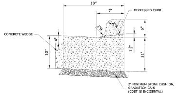
**COMBINATION CONCRETE CURB & GUTTER** TYPE B-6.12 (SPECIAL)
