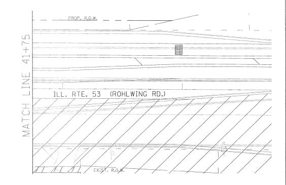
NOTE: THE VIDEO DETECTION ZONES SHOWN ON THE PLANS ARE FOR CONSTRUCTION STAGE 1 - SUBSTAGE 1 AND SHALL BE REDEFINED FOR EACH CONSTRUCTION STAGE AS A PART OF "TEMPORARY TRAFFIC SIGNAL INSTALLATION" WORK.
