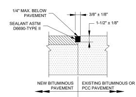
NOTE: ALL BITUMINOUS/BITUMINOUS JOINT SEALING TO BE PAID UNDER SAW AND SEAL BITUMINOUS JOINTS, ITEM AR401660.
