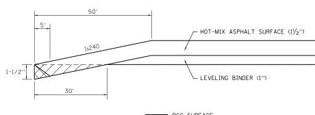
PCC SURFACE REMOVAL BUTT JOINT
