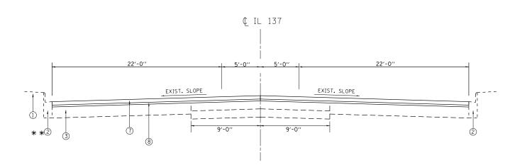
PROPOSED TYPICAL SECTION ILL (137) / BUCKLEY ROAD STA. 50+14 TO STA. 52+86 STA. 54+37 TO STA. 135+00 STA. 151+67 TO STA. 163+82 CROWN CROSS SECTION
