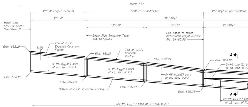
PARTIAL ELEVATION - SOLDIER PILE WALL
