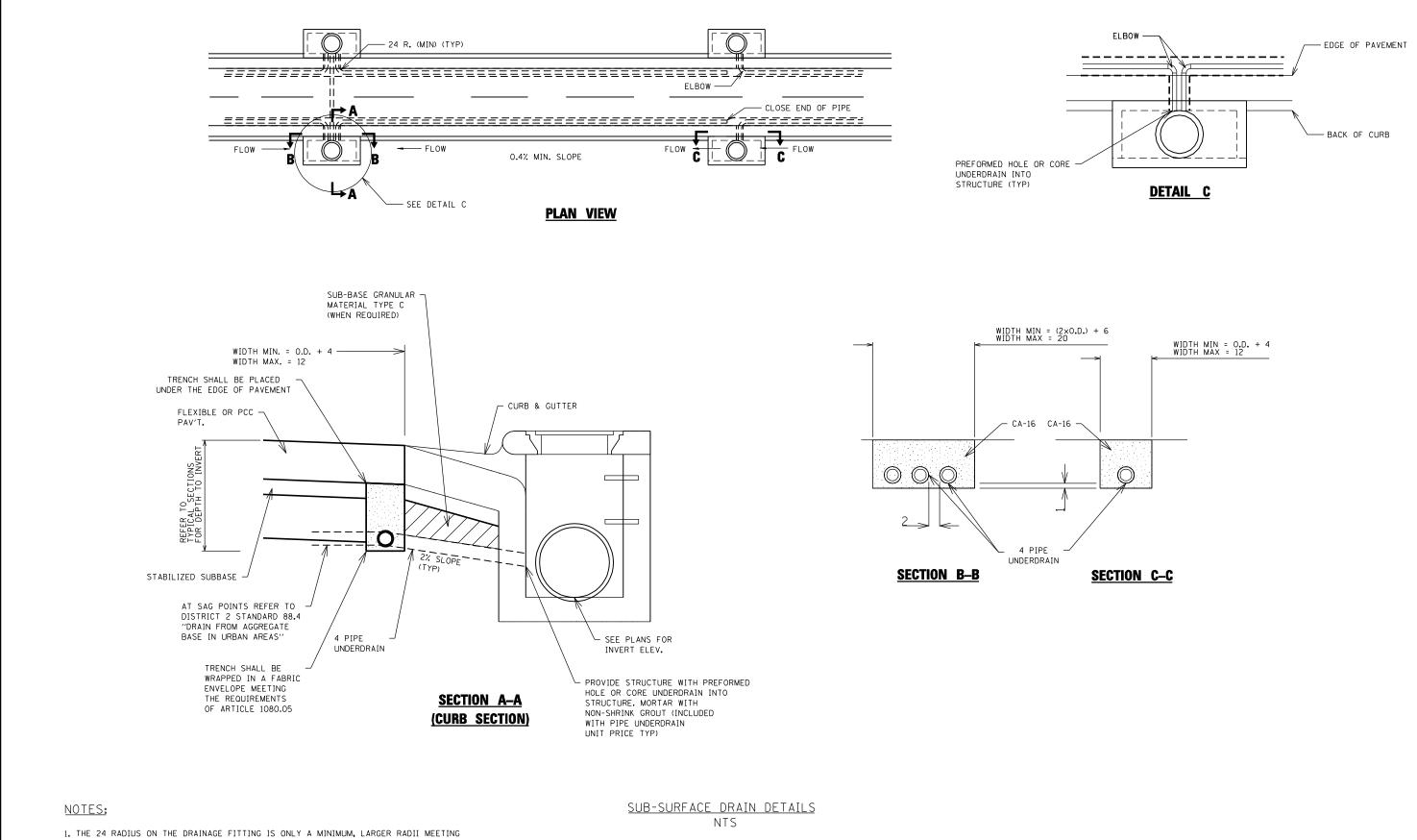
THE 24 RADIUS ON THE DRAINAGE FITTING IS ONLY A MINIMUM, LARGER RADII MEETIN THE APPROVAL OF THE ENGINEER MAY BE SUBSTITUTED.
