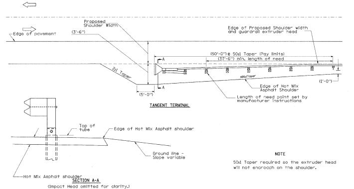
DETAILS: TEMPORARY BITUMINOUS CONCRETE TRANSITIONS; BUTT JOINT; BITUMINOUS SHOUDER AT GUARDRAIL TERMINAL SN 028-0075
