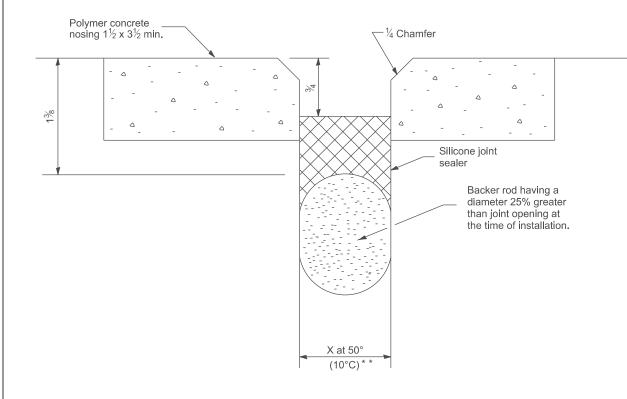
SILICONE JOINT SEAL (CONCRETE DETAILS)
