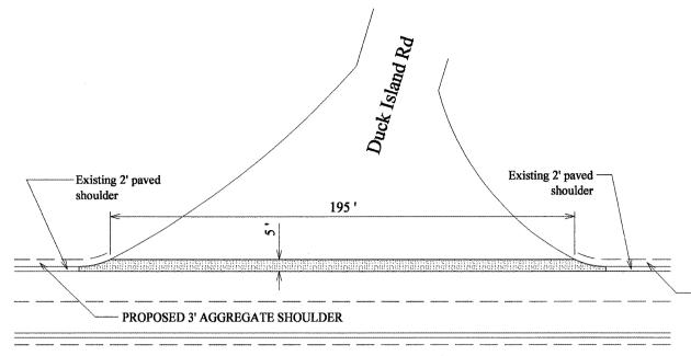
PROPOSED 3' AGGREGATE SHOULDER AND PROPOSED GUARDRAIL AGGREGATE EROSION CONTROL
