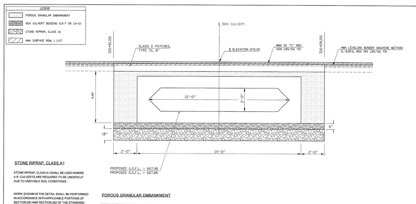
POROUS GRANULAR EMBANKMENT SHALL EXTEND 2 FT. BEYOND THE AGGREGATE SHOULDER
