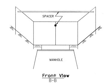
EROSION CONTROL AT OPEN GRATE MAN HOLE
