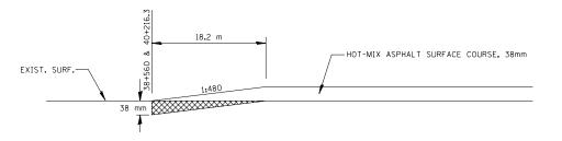
HOT-MIX ASPHALT SURFACE REMOVAL (VARIABLE DEPTH)
