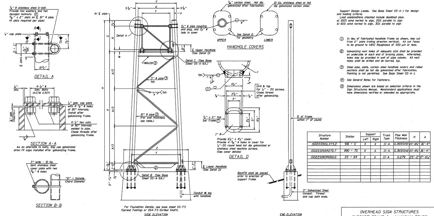
10" Ø PIPE TRUSS SUPPORT FRAME
