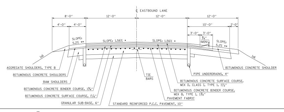
\* SLOPE VARIES FOR SUPERELEVATION IN CURVES.
