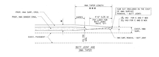
TYPICAL BUTT JOINT AND HMA TAPER
