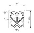
PREFORMED JOINT SEAL
