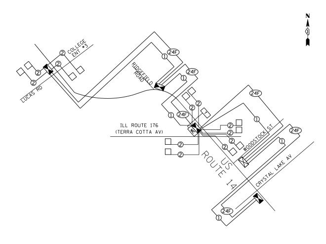
TRAFFIC SIGNAL SYSTEM INTERCONNECT SCHEMATIC
