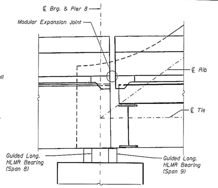
**SECTION THROUGH EXPANSION JOINT PIER 8**
