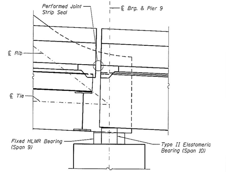
**SECTION THROUGH EXPANSION JOINT PIER 9**
