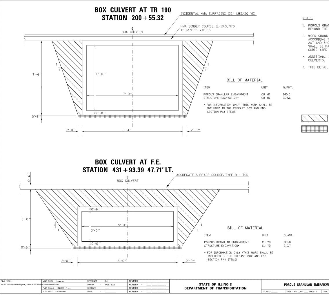
1. POROUS GRANULAR EMBANKMENT SHALL EXTEND 2'-O'' BEYOND THE AGGREGATE OR EARTH SHOULDER.
