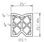
PREFORMED JOINT SEAL
