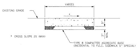
ALL REQUIRED EARTH EXCAVATION TO CONSTRUCT P.C.C. SIDEWALK ACCORDING TO ADA REQUIREMENTS SHALL BE INCIDENTAL TO THE P.C.C. SIDEWALK 5 INCH SPECIAL
