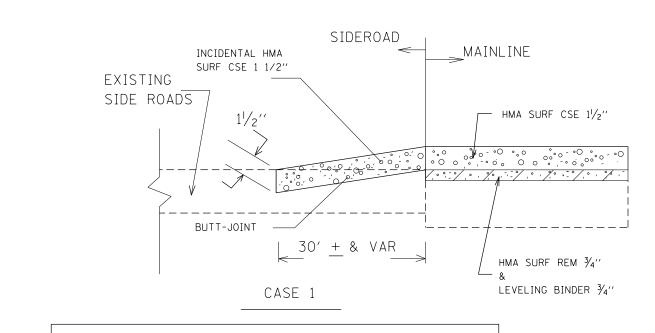
TREATMENT FOR CONCRETE OR BITUMINOUS SIDEROADS <u>WITHOUT</u> MAINLINE GUTTER
