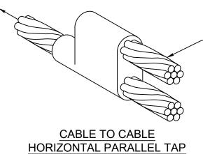
TAP CONDUCTOR SHALL BE ROUTED IN THE DIRECTION TOWARDS THE NEAREST GROUND ROD
