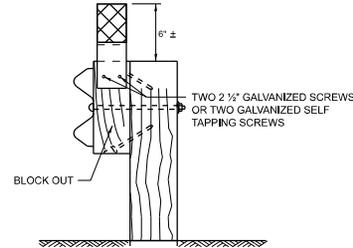
MOUNTED ON A GUARDRAIL BLOCK OUT
