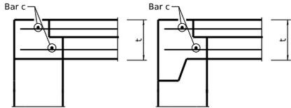
**FLAT SLAB TOP JOINT CONFIGURATIONS**
