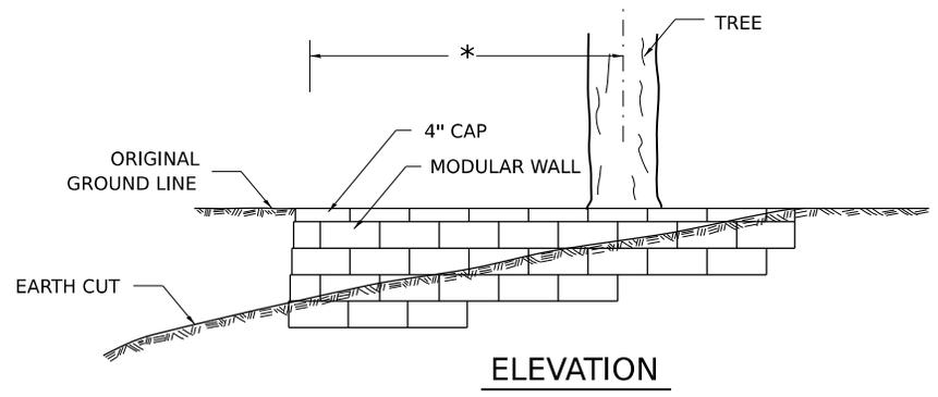
HEIGHT OF WALL DEPENDENT ON SLOPE OF THE CUT.
