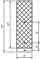
② REPLACING 2 BUTTON DELINEATOR
