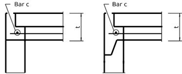
**FLAT SLAB TOP JOINT CONFIGURATIONS**
